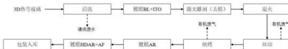
图2-41 激光雷达视窗生产工艺流程图
