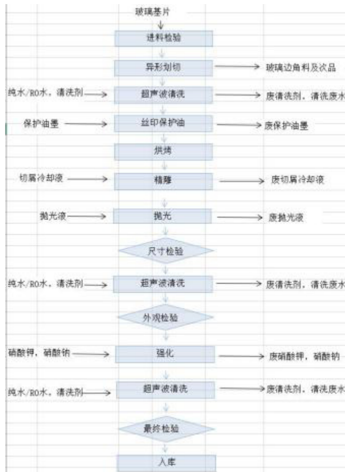
图2-37 研发产品手机盖板生产工艺流程
