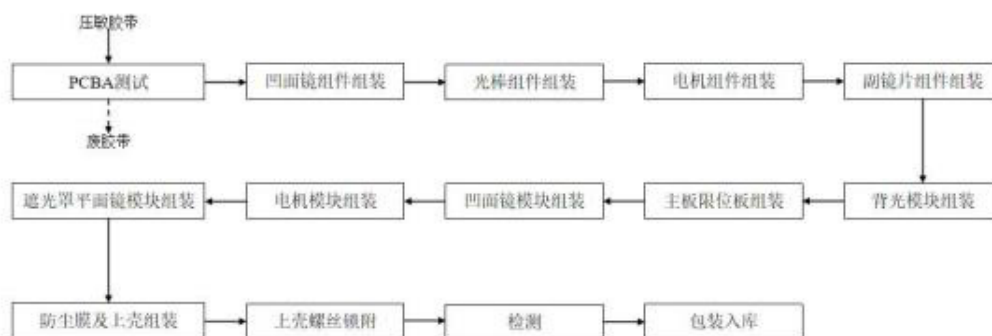
图2-40 车载抬头显示（HUD）生产工艺流程图
