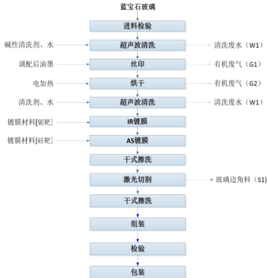
图2-20 米兰项目生产工艺流程
